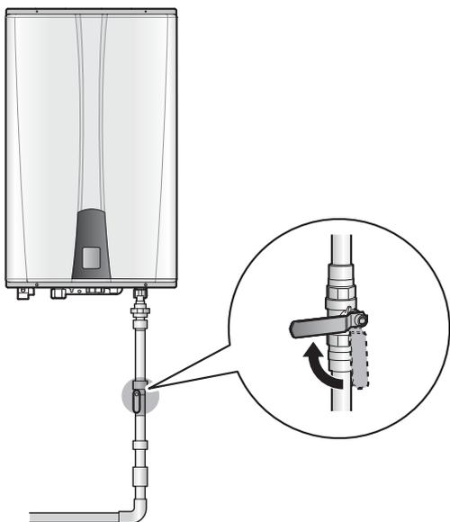
5. 彻底打开所有热水龙头。残留在排水管道中的水将排尽。
