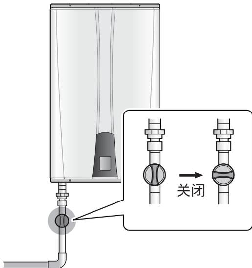
4. 关闭进水口到热水炉的供水阀。如果此处没有阀门, 请关闭主水管的供水。
