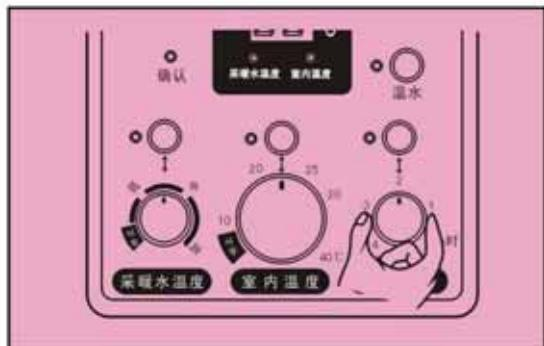
3. 锅炉启动20分钟后，按设定值停止工作，依次重复工作（锅炉正在燃烧时，运转灯亮）
