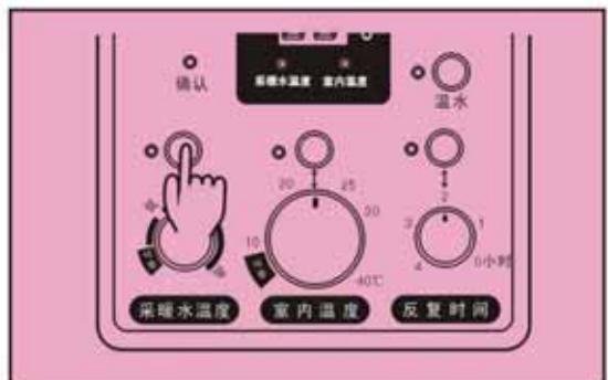
2. 把取暖水温度调节器左右旋转，设定所需取暖水温度。
