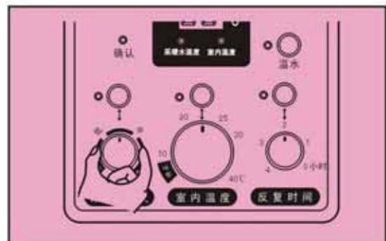
3. 按取暖水温度设定值运转锅炉，锅炉正常燃烧时，运转显示灯亮。
