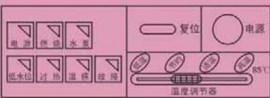
电源：灯亮表示锅炉已接通电源。
